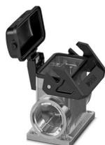
Embase en saillie B10, avec étrier longitudinal, matériau: Aluminium coulé sous pression, résistant à l'eau de mer, matériau du couvercle de protection: PC, nombre de sorties: 2, latérale, 2x M32, hauteur: 74,5 mm, presse-étoupe: sans, capot de protection: oui, Standard
