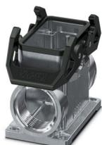
Embase en saillie B10, avec étrier transversal, matériau: Aluminium coulé sous pression, résistant à l'eau de mer, nombre de sorties: 2, latérale, 2x M32, hauteur: 74,5 mm, presse-étoupe: sans, Standard
