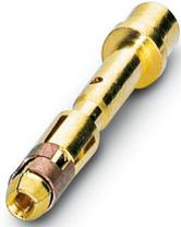
Contact à sertir, Connecteur femelle, tournés, diamètre de contact: 1 mm, zone de sertissage: 0,5 mm<sup>2</sup> ... 1,5 mm<sup>2</sup>, Produit de remplacement selon RoHS II sans exception 6c (Pb < 0,1 %) référence : 1238320
