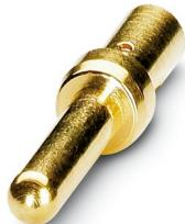
Contact à sertir, Mâle, tournés, diamètre de contact: 1 mm, zone de sertissage: 0,14 mm<sup>2</sup> ... 0,56 mm<sup>2</sup>, Produit de remplacement selon RoHS II sans exception 6c (Pb < 0,1 %) référence : 1238328
