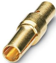
Contact à sertir, Connecteur femelle, tournés, diamètre de contact: 2 mm, zone de sertissage: 1,5 mm<sup>2</sup> ... 2,5 mm<sup>2</sup>, Produit de remplacement selon RoHS II sans exception 6c (Pb < 0,1 %) référence : 1238332
