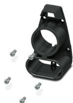
CHARX connect, Kit de réparation, Accessoires, avec cadre d'enchâssement échangeable, Avec 5 vis à tête plate M4X10 et à entraînement de sécurité Torx (IPR TORX PLUS® IEC 60321-36) pour le changement du cadre d'enchâssement des connecteurs de charge côté véhicule, CCS type 1, CEI 62196-3-1, SAE J1772, Montage vissé, boîtiers: noir, Changement sans vidange du fluide de refroidissement
