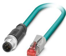
Câble de réseau, Ethernet CAT5 (100 Mbit/s), 4-pôles, blindé, connecteur mâle droit M12, détrompage: D SPEEDCONNEC / IP67, sur connecteur mâle droit RJ45 / IP20, longueur de câble: 30 m
