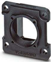
Cadre de montage RJ45, IP67, pour isolants femelles modulaires (Keystone), pour découpe de montage rectangulaire, avec joint, sans vis de fixation, coloris : noir
