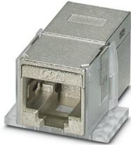
Prolongateur RJ45, indice de protection: IP20, nombre de pôles: 8, 10 Gbit/s, CAT6<sub>A</sub>, matériau: Métal, type de raccordement: Prolongateur, sortie du câble: droit, Exécution Freenet pour une utilisation avec des cadres IP67 et des blocs de prise, Ethernet
