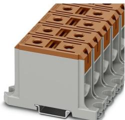
Bloc de jonction de puissance, tension nominale: 1000 V, intensité nominale: 220 A, nombre de connexions: 2, nombre de pôles: 1, type de raccordement: Raccordement vissé, Section de référence: 95 mm<sup>2</sup>, section : 16 mm<sup>2</sup> - 95 mm<sup>2</sup>, Section de référence: 95 mm<sup>2</sup>, section : 16 mm<sup>2</sup> - 95 mm<sup>2</sup>, type de montage: NS 35/15, NS 35/7,5, coloris: marron
