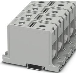
Bloc de jonction de puissance, tension nominale: 1000 V, intensité nominale: 290 A, nombre de connexions: 2, nombre de pôles: 1, type de raccordement: Raccordement vissé, Section de référence: 150 mm<sup>2</sup>, section : 35 mm<sup>2</sup> - 150 mm<sup>2</sup>, Section de référence: 150 mm<sup>2</sup>, section : 35 mm<sup>2</sup> - 150 mm<sup>2</sup>, type de montage: NS 35/15, NS 35/7,5, coloris: gris
