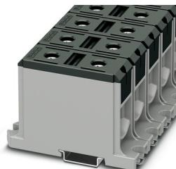
Bloc de jonction de puissance, tension nominale: 1000 V, intensité nominale: 290 A, nombre de connexions: 2, nombre de pôles: 1, type de raccordement: Raccordement vissé, Section de référence: 150 mm<sup>2</sup>, section : 35 mm<sup>2</sup> - 150 mm<sup>2</sup>, Section de référence: 150 mm<sup>2</sup>, section : 35 mm<sup>2</sup> - 150 mm<sup>2</sup>, type de montage: NS 35/15, NS 35/7,5, coloris: noir
