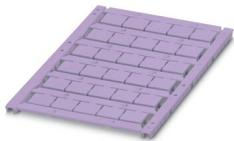
Repères pour blocs de jonction, Planche, violet, vierge, repérable avec : TOPMARK NEO, LASER TOPMARK, BLUEMARK ID COLOR, BLUEMARK ID, BLUEMARK CLED, THERMOMARK PRIME, THERMOMARK CARD 2.0, THERMOMARK CARD, type de montage: encliqueter, pour bloc de jonction au pas de : 12 mm, surface utile: 10,8 x 9,6 mm, Nombre d'étiquettes: 30
