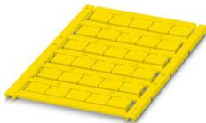
Repères pour blocs de jonction, Planche, jaune, vierge, repérable avec : TOPMARK NEO, LASER TOPMARK, BLUEMARK ID COLOR, BLUEMARK ID, BLUEMARK CLED, THERMOMARK PRIME, THERMOMARK CARD 2.0, THERMOMARK CARD, type de montage: encliquetage, pour bloc de jonction au pas de : 12 mm, surface utile: 10,8 x 9,6 mm, Nombre d'étiquettes: 30
