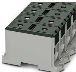
Bloc de jonction de puissance, tension nominale: 1000 V, intensité nominale: 380 A, nombre de connexions: 2, nombre de pôles: 1, type de raccordement: Raccordement vissé, Section de référence: 240 mm<sup>2</sup>, section : 35 mm<sup>2</sup> - 240 mm<sup>2</sup>, Section de référence: 240 mm<sup>2</sup>, section : 35 mm<sup>2</sup> - 240 mm<sup>2</sup>, type de montage: Montage vissé, coloris: noir
