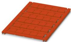
Repères pour blocs de jonction, Planche, rouge, vierge, repérable avec : TOPMARK NEO, LASER TOPMARK, BLUEMARK ID COLOR, BLUEMARK ID, BLUEMARK CLED, THERMOMARK PRIME, THERMOMARK CARD 2.0, THERMOMARK CARD, type de montage: encliquetage, pour bloc de jonction au pas de : 12 mm, surface utile: 10,8 x 9,6 mm, Nombre d'étiquettes: 30
