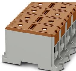
Bloc de jonction de puissance, tension nominale: 1000 V, intensité nominale: 380 A, nombre de connexions: 2, nombre de pôles: 1, type de raccordement: Raccordement vissé, Section de référence: 240 mm<sup>2</sup>, section : 35 mm<sup>2</sup> - 240 mm<sup>2</sup>, Section de référence: 240 mm<sup>2</sup>, section : 35 mm<sup>2</sup> - 240 mm<sup>2</sup>, type de montage: Montage vissé, coloris: marron
