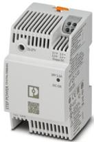
Alimentation à découpage primaire, STEP POWER, Raccordement Push-in, Montage sur rail DIN et montage direct, entrée: 1 phasée, sortie : 24 V DC / 2,5 A, réglable de 22 V DC ... 27 V DC
