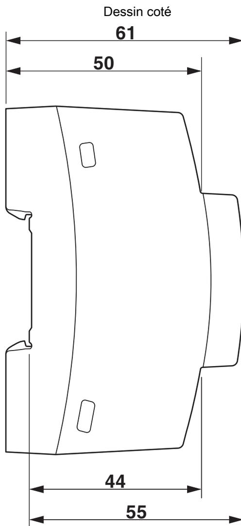
Encombrement de l'appareil (cotes en mm)
