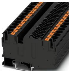
Bloc de jonction-fusibles, type de fusible: Plat, type de fusible: C, tension nominale: 400 V, intensité nominale: 25 A, type de raccordement: Raccordement Push-in, Section de référence: 10 mm<sup>2</sup>, section : 0,5 mm<sup>2</sup>- 16 mm<sup>2</sup>, type de montage: NS 35/7,5, NS 35/15, coloris: noir
