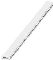
Ruban de repérage ZB, plat, à commander : par bandes, blanc, impression selon les indications du client, type de montage: encliquetage dans la rainure de repérage plate, pour bloc de jonction au pas de : 10 mm, surface utile: 5,15 x 10 mm, Nombre d'étiquettes: 10
