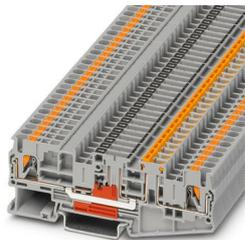
Bloc de jonction à couteau de sectionnement, pour parafoudre basse tension CLIXTRAB, Bloc de jonction de sectionnement pour parafoudre basse tension, tension nominale: 400 V, intensité nominale: 20 A, type de raccordement: Raccordement Push-in, Section de référence: 2,5 mm<sup>2</sup>, section : 0,14 mm<sup>2</sup> - 4 mm<sup>2</sup>, montage: NS 35/7,5, NS 35/15, coloris: gris
