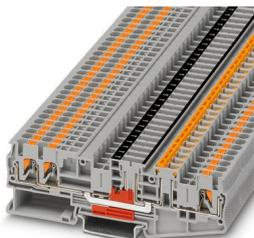
Bloc de jonction à couteau de sectionnement, pour parafoudre basse tension CLIXTRAB, tension nominale: 400 V, intensité nominale: 20 A, type de raccordement: Raccordement Push-in, Section de référence: 2,5 mm<sup>2</sup>, section : 0,14 mm<sup>2</sup> - 4 mm<sup>2</sup>, montage: NS 35/7,5, NS 35/15, coloris: gris
