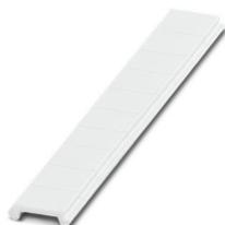
Ruban de repérage ZB, plat, Rubans, blanc, vierge, repérable avec : CMS-P1-PLOTTER, PLOTMARK, type de montage: encliquetage, pour bloc de jonction au pas de : 4 mm, surface utile: 4,2 x 5,2 mm, Nombre d'étiquettes: 10
