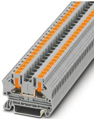
Blocs de jonction simple, tension nominale: 1000 V, intensité nominale: 32 A, nombre de connexions: 2, type de raccordement: Raccordement Push-in, Section de référence: 4 mm<sup>2</sup>, section : 0,2 mm<sup>2</sup> - 6 mm<sup>2</sup>, type de montage: NS 35/7,5, NS 35/15, coloris: gris
