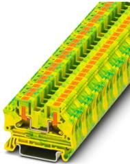
Bloc de jonction pour conducteur de protection, nombre de connexions: 2, type de raccordement: Raccordement Push-in, 1er étage, Section de référence: 4 mm<sup>2</sup>, section : 0,2 mm<sup>2</sup> - 6 mm<sup>2</sup>, type de montage: NS 35/7,5, NS 35/15, coloris: vert/jaune
