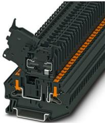
Bloc de jonction-fusibles, type de fusible: Verre / Céramique / ..., type de fusible: G / 5 x 20, tension nominale: 500 V, intensité nominale: 6,3 A, type de raccordement: Raccordement Push-in, 1er étage, Section de référence: 4 mm<sup>2</sup>, section : 0,2 mm<sup>2</sup>- 6 mm<sup>2</sup>, type de montage: NS 35/7,5, NS 35/15, coloris: noir
