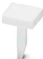
Repères pour blocs de jonction, Pointe, blanc, vierge, repérable avec : Crayon de marquage, type de montage: enfichage, pour bloc de jonction au pas de : 4,2 mm, surface utile: 4 x 4 mm
