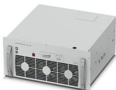
CHARX power basic, Module de charge rapide pour la mise en place de stations de charge DC, entrée: 3 phasée, sortie : 200 V DC...920 V DC / 125 A. Pour le fonctionnement du module de puissance DC, il faut l'armoire électrique correspondante CHARX PS-CAB/4x87.5KW (Référence 1165442)
