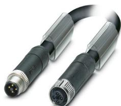
Conducteur de puissance, 4-pôles, connecteur mâle droit M12, détrompage: T, sur Connecteur femelle droit M12, détrompage: T, longueur de câble: 2 m, pour courant continu jusqu'à 12 A/63 V
