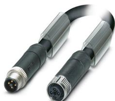
Conducteur de puissance, 4-pôles, connecteur mâle droit M12, détrompage: T, sur Connecteur femelle droit M12, détrompage: T, longueur de câble: 10 m, pour courant continu jusqu'à 12 A/63 V
