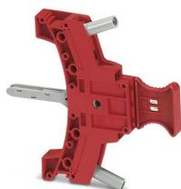
Connecteur d'essai, avec résistance intégrée 100 mOhm, 3 W, tension nominale: 400 V, intensité nominale: 1 A, Section de référence: 2,5 mm<sup>2</sup>, coloris: rouge
