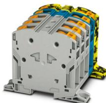
Bloc de jonction de puissance, Avec alvéole pour fiche test, tension nominale: 1000 V, intensité nominale: 150 A, nombre de connexions: 8, nombre de pôles: 5, type de raccordement: Raccordement PowerTurn, 1er étage, section : 10 mm<sup>2</sup> - 70 mm<sup>2</sup>, type de montage: vissage direct, coloris: gris/noir-jaune
