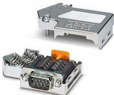
Connecteur mâle D-SUB, 9 pôles, picot, arrivée du câble à 35°, système de bus : PROFIBUS DP jusqu'à 12 MBit/s, résistance de terminaison connectable via commutateur coulissant, brochage : 3, 5, 6, 8 ; blocs de jonction à vis
