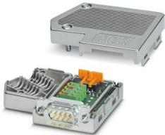
Connecteur D-SUB, 9 pôles, tige, deux arrivées de câble à 35°, système de bus : PROFIBUS-DP jusqu'à 12 MBit/s, résistance de terminaison activable via commutateur coulissant, affectation des broches : 3, 5, 6, 8 ; blocs de jonction à ressort
