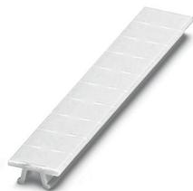
Ruban de repérage ZB, à commander : par bandes, blanc, impression selon les indications du client, type de montage: encliquetage dans la rainure de repérage élevée, pour bloc de jonction au pas de : 6,2 mm, surface utile: 6,15 x 10,5 mm, Nombre d'étiquettes: 10
