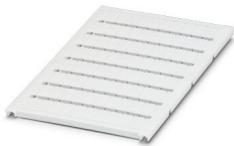
Repères pour blocs de jonction, à commander : sous forme de planche, blanc, impression selon les indications du client, type de montage: encliquetage dans la rainure de repérage élevée, pour bloc de jonction au pas de : 6,2 mm, surface utile: 5,6 x 10,5 mm, Nombre d'étiquettes: 80
