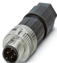
Connecteur, 4-pôles, connecteur mâle droit M12, A, Raccordement Push-in, matériau de la molette: Zinc moulé sous pression, nickelé, diamètre extérieur du câble 4 mm ... 8 mm
