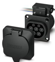
CHARX connect modular, Prise côté infrastructure, Rectangulaire, Basic, Kit, avec capot de protection carré, pour la charge en courant alternatif (AC) des véhicules électriques (VE), Type 2, CEI 62196-2, 32 A / 480 V (AC), sans fils individuels, actionneur de verrouillage: 12 V, 4 pôles, Montage sur la paroi arrière, Filetage M5, boîtiers: noir, Logo PHOENIX CONTACT
