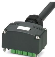
Capot de raccordement, application : Répartiteur pour capteurs/actionneurs, type de raccordement: Connecteur femelle M12 SPEEDCONNEC Plastique, nombre de prises: 8, affectation des prises: double, affichage d'état: Non; racc. câble multicond.: Raccordement vissé enfichable 180°, PUR/PVC, longueur du câble: 20 m, blindage: non
