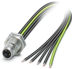
Connecteur d'appareil face arrière, Puissance, 5-pôles, Connecteur mâle, droit, M12, détrompage: K M12, Montage face arrière, M16 x 1,5, Cordons individuels, longueur de câble: 0,5 m, 2,50 mm<sup>2</sup>, Cordon PEX, Produit de remplacement selon RoHS II sans exception 6c (Pb < 0,1 %) référence : 1238380
