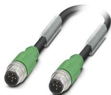
Câble pour capteurs/actionneurs, 5-pôles exempt d'halogène, blindé, connecteur mâle droit M12, détrompage: A, sur connecteur mâle droit M12, détrompage: A, longueur de câble: 12 m
