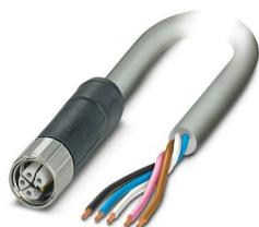
Conducteur de puissance, 5-pôles exempt d'halogène, extrémité libre, sur Connecteur femelle droit M12, détrompage: L, longueur de câble: 15 m, pour courant continu jusque 16 A / 63 V
