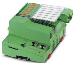
Contrôleur Inline avec interface PWM impulsion/direction, interfaces RS-485/422, entrées analogiques (0 ... 10 V) et sorties analogiques (0 ... 10 V), possibilité de programmation selon IEC 61131-3
