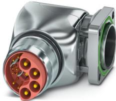
M23, Embases paroi avant, série: SH, coudé rotatif, Pour verrouillage standard et SPEEDCON, Nombre de pôles: 4+4+PE / 3+N+PE, Sens de rotation: standard, type de contact: Mâle, Raccordement à sertir, Joint torique axial, 4x Ø 3,2, cote de bride: 28 mm x 28 mm, détrompage: N
