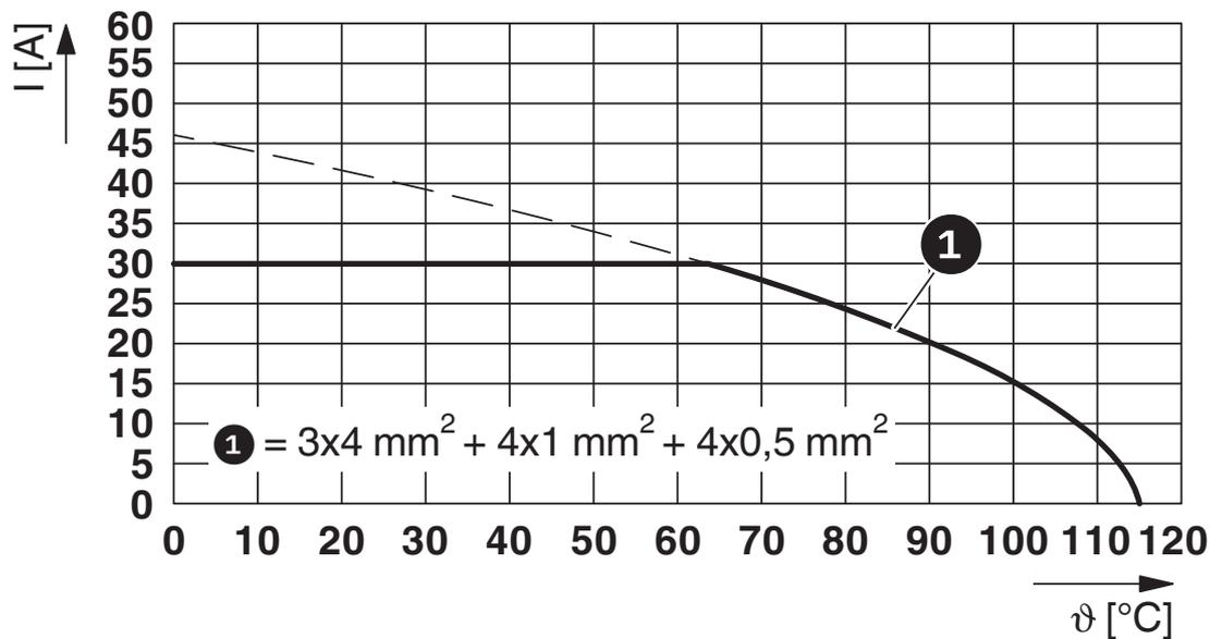
I = intensité, θ = température ambiante, contacts de puissance A-C : 3 x jusqu'à 30 A, contacts de signalisation : 4 x 2 A stables, contacts de données : 4 x 1 A stables
