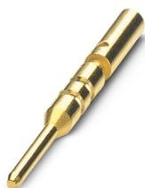
Contact à sertir, Mâle, tournés, diamètre de contact: 0,8 mm, zone de sertissage: 0,34 mm<sup>2</sup> ... 0,5 mm<sup>2</sup>, L'article est sans plomb, conformément à la directive RoHS II, sans exception 6c (Pb < 0,1 %)
