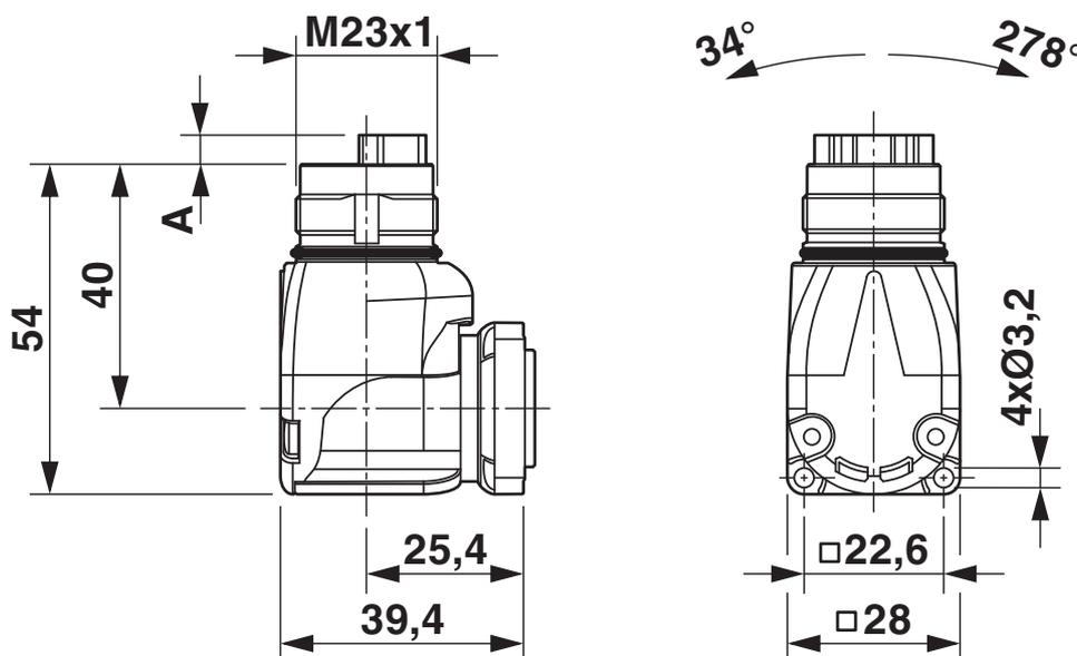
Type de connecteur mâle : dimension A = 4,7 mm, type de connecteur femelle : dimension A = 0 mm
