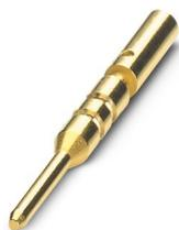
Contact à sertir, Mâle, tournés, diamètre de contact: 0,8 mm, zone de sertissage: 0,06 mm<sup>2</sup> ... 0,34 mm<sup>2</sup>, L'article est sans plomb, conformément à la directive RoHS II, sans exception 6c (Pb < 0,1 %)
