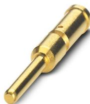
Contact à sertir, Mâle, tournés, diamètre de contact: 2 mm, zone de sertissage: 0,25 mm<sup>2</sup> ... 2,5 mm<sup>2</sup>, L'article est sans plomb, conformément à la directive RoHS II, sans exception 6c (Pb < 0,1 %)
