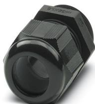
Presse-étoupe, matériau du raccordement vissé: PA, diamètre extérieur du câble 18 mm ... 25 mm, blindage: non, filetage de raccordement: M32 x 1,5, coloris: noir foncé RAL 9005
