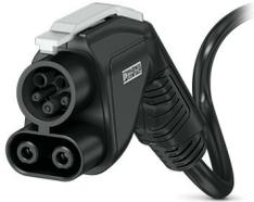
CHARX connect compact, Câble de charge DC, avec connecteur de charge côté véhicule et extrémité de câble libre, pour la charge en courant continu (DC) des véhicules électriques (VE), avec contact CS raccordé, avec capteurs de température analogiques, CCS type 1, SAE J1772, CEI 62196-3, 40 A / 1000 V (DC), Logo PHOENIX CONTACT, câble: 5 m, noir, droit
