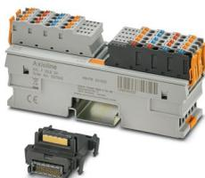
Axioline F, Maître IO-Link, ports IO-Link Classe A: 8, type de raccordement: Raccordement Push-in, connectique: 3 fils, vitesse de transmission dans le bus local: 100 MBit/s, indice de protection: IP20, incl. module d'embase de bus et connecteurs Axioline F
