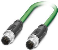
Câble de réseau, PROFINET CAT5 (100 Mbit/s), EtherCAT® CAT5 (100 Mbit/s), 4-pôles, blindé (Advanced Shielding Technology), connecteur mâle droit M12, détrompage: D / IP67, sur connecteur mâle droit M12, détrompage: D / IP67, longueur de câble: 2 m
