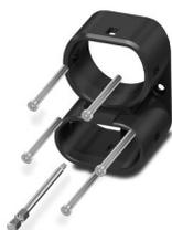
CHARX connect standard, Kit de réparation, Accessoires, avec cadre d'enfichage échangeable, avec 5 vis à tête bombée M4X45 avec entraînement de sécurité Torx, Avec embout spécial (embout 867/4 IPR TORX PLUS®, 20 IPR x 89 mm) pour tournevis de sécurité, pour le changement du cadre d'enfichage des connecteurs de charge côté véhicule, CCS type 2, CEI 62196-3, boîtiers: noir, Il n'est pas nécessaire d'ouvrir le boîtier du connecteur de charge du véhicule, pour changer le cadre du schéma d'enfichage.
