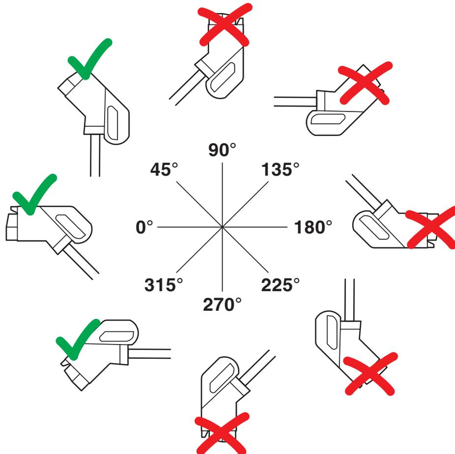
Monter la position de stationnement dans la station de charge, uniquement de manière à ce que le consommateur final ne puisse pas mettre le connecteur de charge du véhicule la tête en bas, (90° à 270°). Cependant, il est possible d'installer le connecteur tourné vers le haut (45°) ou vers le bas (315°) dans une position de stationnement.
