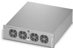
CHARX power basic, Module de charge rapide pour la mise en place de stations de charge DC, Montage en rack de 19", Bus CAN, sortie : 150 V DC...1000 V DC / 0 A...100 A
