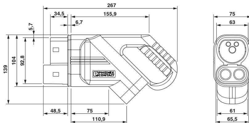
S'assurer que le connecteur de charge côté véhicule est enfileté pendant toute la durée de l'arrêt du chargement dans un support de connecteur de charge adapté, qui assure une protection minimale IP24 selon la norme CEI 61851-1. Pour fabriquer un tel support de connecteur de charge, utilisez les dimensions du connecteur de charge côté véhicule. Vous trouverez également des dimensions détaillées dans la zone des téléchargements.
