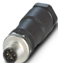
Connecteur de puissance, 4-pôles, connecteur mâle droit M12, S, Raccordement vissé, matériau de la molette: Zinc moulé sous pression, nickelé, presse-étoupe Pg9, diamètre extérieur du câble 6 mm ... 8 mm, pour courant alternatif jusqu'à 12 A/630 V, Contact 4 à fermeture
