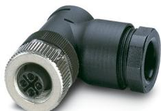
Connecteur de puissance, 4-pôles, connecteur femelle coudé M12, S, Raccordement vissé, matériau de la molette: Zinc moulé sous pression, nickelé, presse-étoupe Pg9, diamètre extérieur du câble 6 mm ... 8 mm, pour courant alternatif jusque 12 A/630 V
