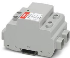
Dispositif paratonnerre / parafoudre pour systèmes à tension continue PV à 2 pôles, isolés et mis à la terre de 1500 V DC, pour montage sur rail DIN, éléments de protection, avec contrôle de la température, affichage de l'état sur le module.
