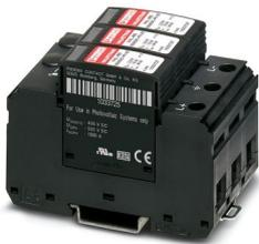
Parafoudre pour systèmes à tension continue PV à 2 pôles, isolés et mis à la terre de 1 500 V DC, pour montage sur rail DIN, élément de base à 3 pôles, trois éléments de protection enfichables, avec contrôle de la température, affichage de l'état sur chaque connecteur.
