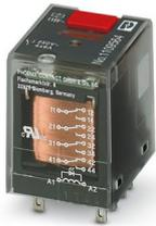
Relais industriel enfichable en version de base avec contacts de puissance, 4 contacts inverseurs, touche de test, DEL d'état, affichage mécanique de position de commutation, tension d'entrée : 115 V AC
