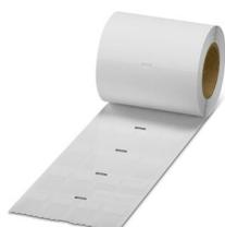
Étiquette d'enroulement de câble, Rouleau, blanc, vierge, repérable avec : THERMOMARK E. 300 (D)/600 (D), THERMOMARK ROLL 2.0, THERMOMARK ROLL, THERMOMARK ROLL X1, THERMOMARK ROLLMASTER 300/600, THERMOMARK X1.2, type de montage: collage, plage de diamètre de câble: 2,9 ... 7,6 mm, diamètre du câble:  $\leq 7,6$  mm, surface utile: 17 x 9 mm, Nombre d'étiquettes: 5000
