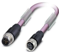
Câble préconfectionné pour bus, CANopen<sup>®</sup>, DeviceNet<sup>™</sup>, 5-pôles exempt d'halogène, blindé, connecteur mâle droit M12, détrompage: A, sur Connecteur femelle droit M12, détrompage: A, longueur de câble: Longueur au choix (0,2... 40,0 m)
