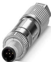
Connecteur de données, CANopen<sup>®</sup>, DeviceNet<sup>™</sup>, 5-pôles, exempt d'halogène, blindé, connecteur mâle droit M12, A, Raccordement autodénudant, matériau de la molette: Zinc moulé sous pression, nickelé, diamètre extérieur du câble 5 mm ... 9,7 mm
