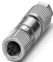
Connecteur de données, CANopen<sup>®</sup>, DeviceNet<sup>™</sup>, 5-pôles, exempt d'halogène, blindé, connecteur femelle droit M12, A, Raccordement autodénudant, matériau de la molette: Zinc moulé sous pression, nickelé, diamètre extérieur du câble 5 mm ... 9,7 mm
