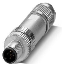
Connecteur de données, CANopen<sup>®</sup>, DeviceNet<sup>™</sup>, 5-pôles, blindé, connecteur mâle droit M12, A, Raccordement à ressort Push-Lock, matériau de la molette: Zinc moulé sous pression, nickelé, diamètre extérieur du câble 4 mm ... 8 mm
