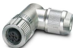
Connecteur de données, CANopen<sup>®</sup>, DeviceNet<sup>™</sup>, 5-pôles, blindé, connecteur femelle coudé M12, A, Raccordement à ressort Push-Lock, matériau de la molette: Zinc moulé sous pression, nickelé, diamètre extérieur du câble 4 mm ... 8 mm
