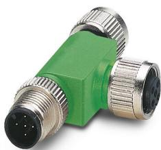
Répartiteur en T, 5-pôles, non blindé, connecteur mâle droit M12, détrompage: A, sur Connecteur femelle droit M12, détrompage: A et Connecteur femelle droit M12, détrompage: A, Répartiteur parallèle
