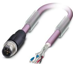
Câble préconfectionné pour bus, CANopen<sup>®</sup>, DeviceNet<sup>™</sup>, 5-pôles exempt d'halogène, blindé, connecteur mâle droit M12, détrompage: A, sur extrémité libre, longueur de câble: Longueur au choix (0,2... 40,0 m)
