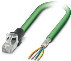
Câble de jonction, indice de protection: IP20, longueur de câble: 0,3 m, nombre de pôles: 4, 100 Mbit/s, CAT5, matériau: PP, type de raccordement: Raccordement Pierce, sortie du câble: droit, PROFINET
