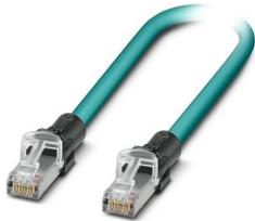
Câble de jonction, indice de protection: IP20, longueur de câble: 2 m, nombre de pôles: 8, 1 Gbit/s, CAT5, matériau: PP, type de raccordement: Raccordement Pierce, section raccordable: AWG 26- 26, sortie du câble: droit, Ethernet
