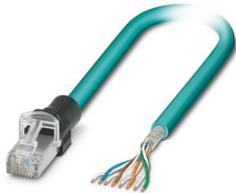
Câble de jonction, indice de protection: IP20, longueur de câble: 0,3 m, nombre de pôles: 8, 1 Gbit/s, CAT5, matériau: PP, type de raccordement: Raccordement Pierce, section raccordable: AWG 26- 26, sortie du câble: droit, Ethernet
